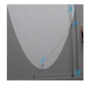
Questo strumento si chiama Parabolografo a corda tesa, e si utilizza per vedere la direzione di P, ossia un pezzo metallico, che scorrendo in basso sull'asse A disegna una parabola, F è il fuoco della parabola e H è la direttrice della nostra parabola.
